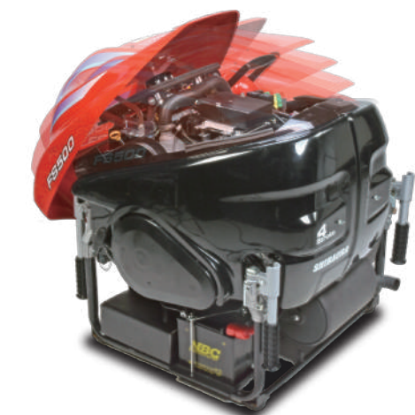
フロントカバーは、止め具なしのリンク機構
