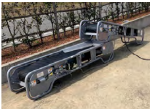
ベルトコンベヤー
