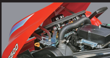
フロントカバーは、止め具なしのリンク機構 点検・メンテナンスが格段に向上
