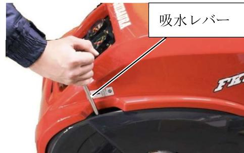
(2) ⑤の吸水レバーを手前に引き真空ポンプを作動させ吸水します。
