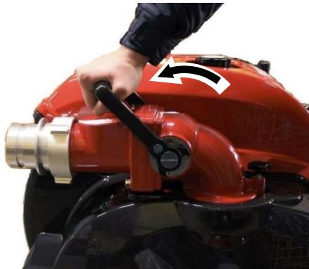
(1) 放水弁レバーを徐々に『→開』の方へ操作し、止まるまで開いてください。筒先の状況に応じて筒先側と連絡を取りながら、スロットルにより圧力を調整してください。
