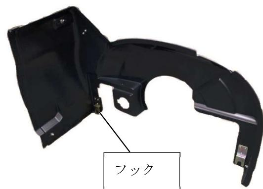
⑧背面左上下 2 つの着脱ノブを受け穴に押し込みながら時計回りに回します。
