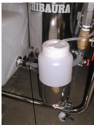
逆洗用ホース
